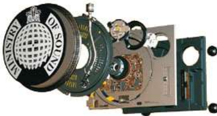
Illustration 1 - Platine vinyle en éclaté
